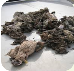
Déchets à la sortie de vis de compactage
